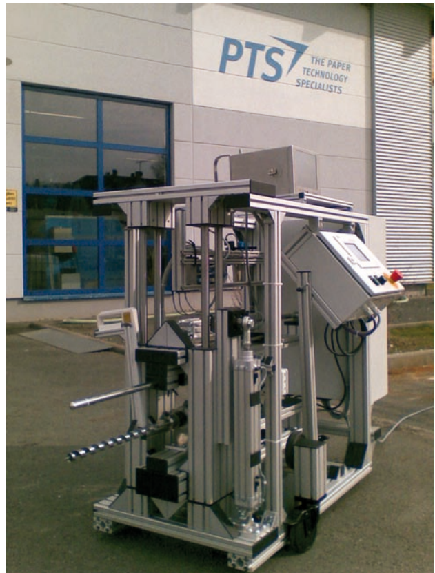
Ansicht des mobilen Messsystems Paper Bale Sensor zur Prüfung von Altpapierballen
