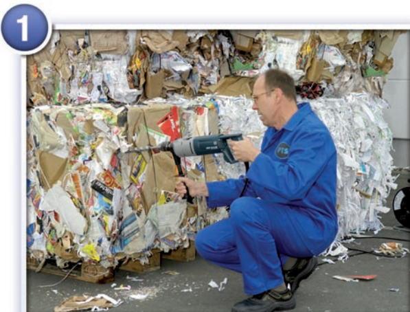
Ein Loch in den Ballen bohren
