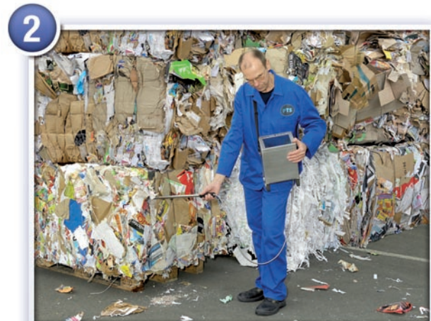
Die Messlanze in das Bohrloch einführen
