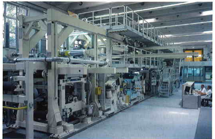
Abb. 3: Gesamtansicht der Anlage mit dem Curtain Coater von Andritz BMB im Vordergrund (Bild: PTS)
