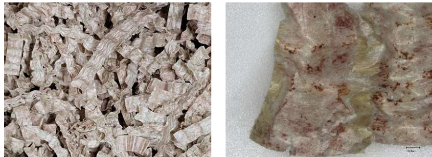
Abbildung 12: Aramidpapierstreifen nach Exposition in Reagenz 5 Übersichtsaufnahme und Detailaufnahme der Streifenoberfläche
