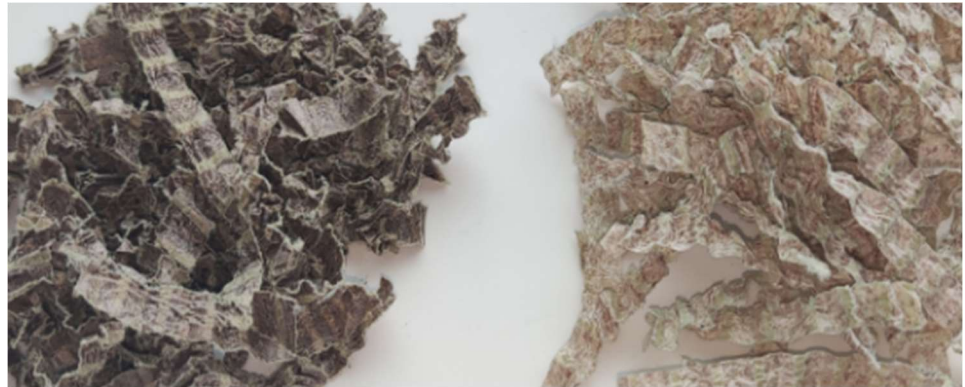
Abbildung 15: Mikrowellenunterstützte Solvolyse: TYP2 - Wabe (links) und TYP1 - Wabe (rechts) nach 2-stündiger Behandlung mit R5
