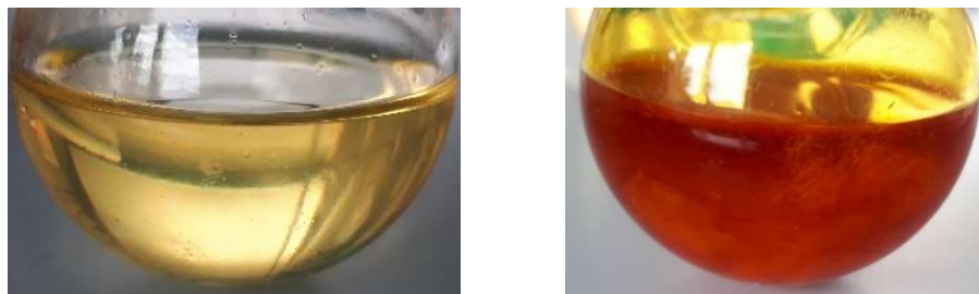
Abbildung 8: Aramidpapiere nach einer Behandlung mit KOH/DMSO-Lösung; links: aufgelöstes meta-Aramidpapier, rechts: teilaufgelöstes para-Aramidpapier
