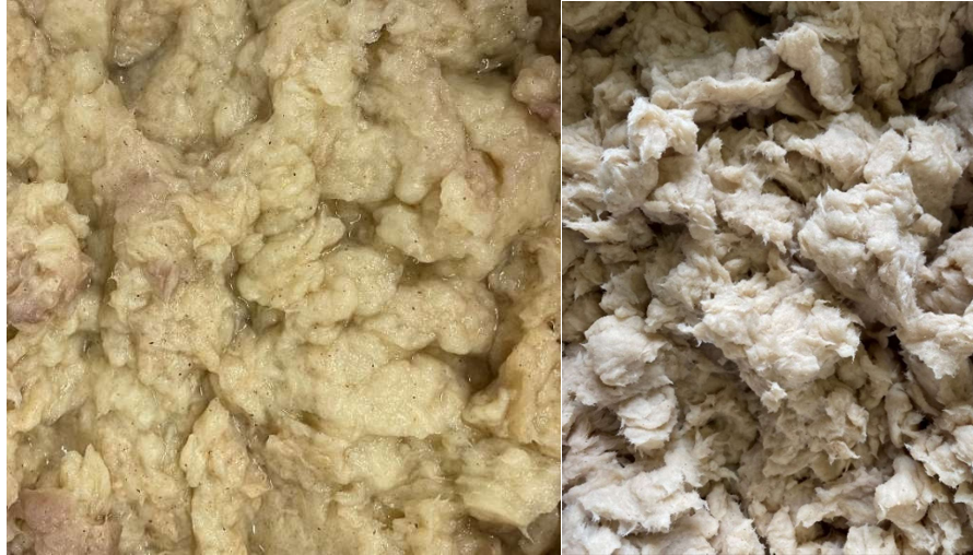
Abbildung 38: Rezyklatprobe vor (links) und nach (rechts) Aufbereitung mittels Vibrations-sieb
