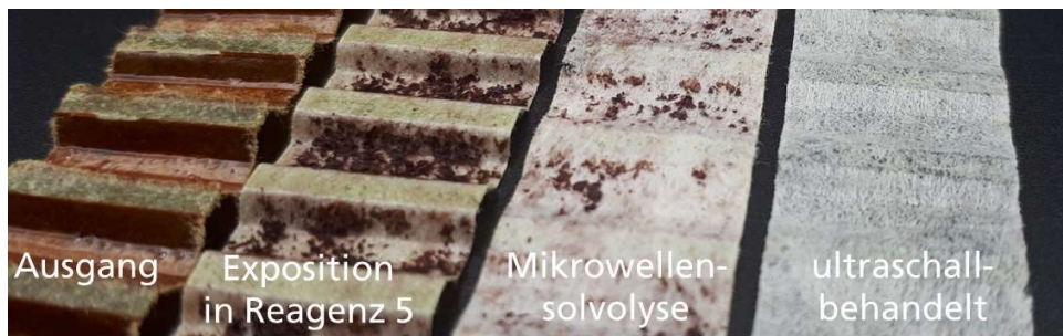
Abbildung 13: Wabenstreifen nach den einzelnen, aufeinanderfolgenden Behandlungsschritten. Die Ultraschallbehandlung erfolgte mit dem Ziel anhaftenden Harzpartikel und den Binder aus dem Faservlies zu lösen.
