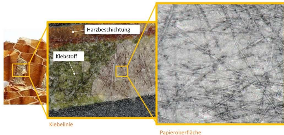
Abbildung 7: Multimaterialverbund (v.l.n.r.): Ausgangswaben, Detailaufnahme Klebstofflinie, Detailaufnahme Aramidkurzfasern, auch als Floc bezeichnet
