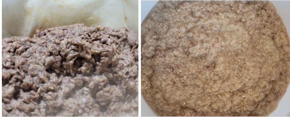
Abbildung 18: Rückstand nach Stufe 2 und gereinigte Faserstoff-Suspension
