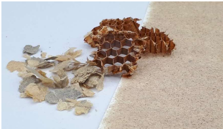
Abbildung 1: Erstes Aramidfaservlies (rechts) hergestellt aus rezyklierten Aramid-Honeycombs (Mitte).
