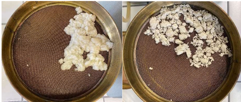
Abbildung 32: Siebturm-Separation (Maschenweite > 400 \mu\text{m} ) - Nasssiebung (Links) & Trockensiebung (Rechts)
