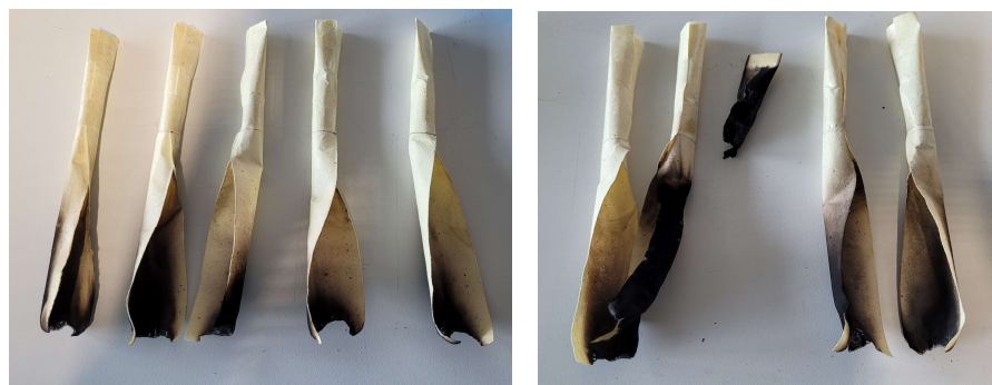
Abbildung 46: Ergebnisse des UL94 VTM – Tests: Papier 60:40:0 (links) und Papier 60:20:20 (rechts).
