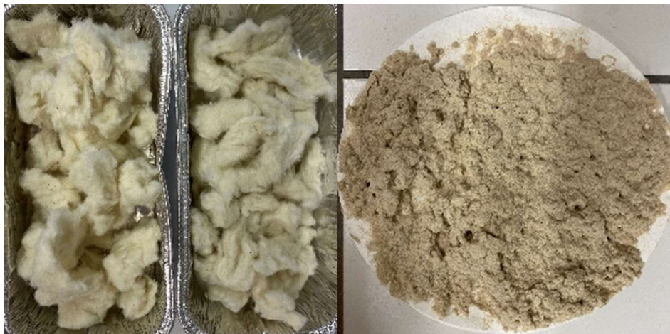
Abbildung 24: Getrocknete aufbereitete Rezyklatfasern (links) und Durchlauf durch 0,15 mm-Schlitzplatte nach Somerville-Fraktionierung
