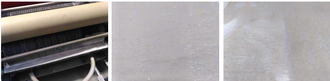
Abbildung 28: Schaumbildung beim Rollenauftrag mittels SUMET-Coater (links), resultierend in ungleichmäßigem Strich (Mitte, rechts).
