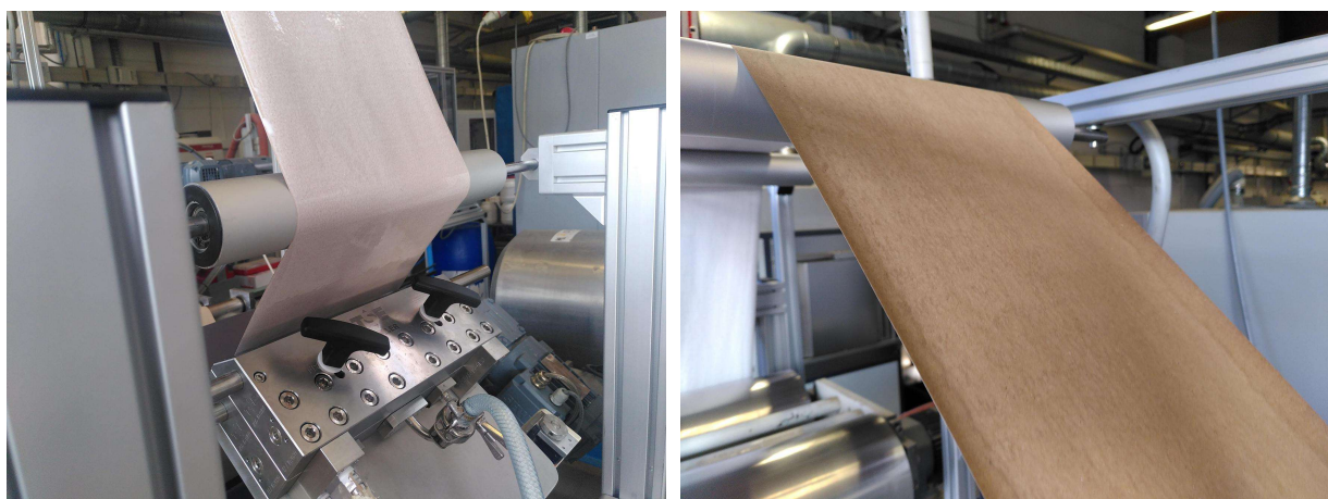
Abbildung 31: Beschichteter Karton, links: Schlitzdüsenauftrag (Tensioned Web), rechts: Rollenauftrag.
