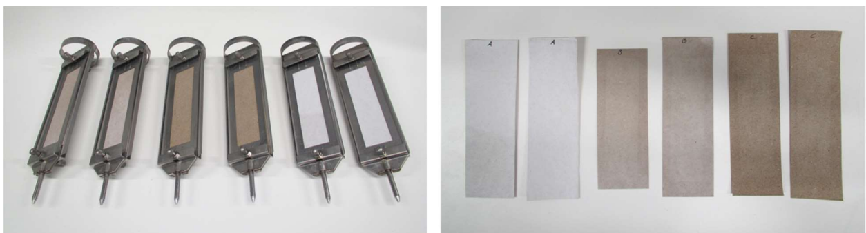
Abbildung 33: Beschichtete Papiermuster vor (links) und nach (rechts) der Xenotest-Bewitterung.
