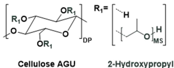
Abbildung 4: Schematische Darstellung der Struktur von Hydroxypropylcellulose zur Bestimmung des molaren Substitutionsgrads.
