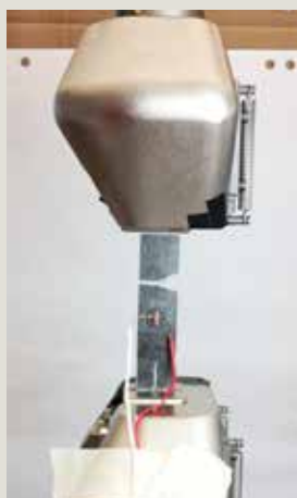
Zugprüfung einer CFK-Probe auf Basis eines Spezialpapiers
