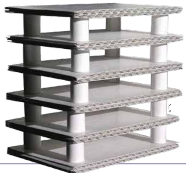
Papierabgeleitete Keramikstruktur für Hochtemperaturanwendungen (Brennhilfsmittel)
