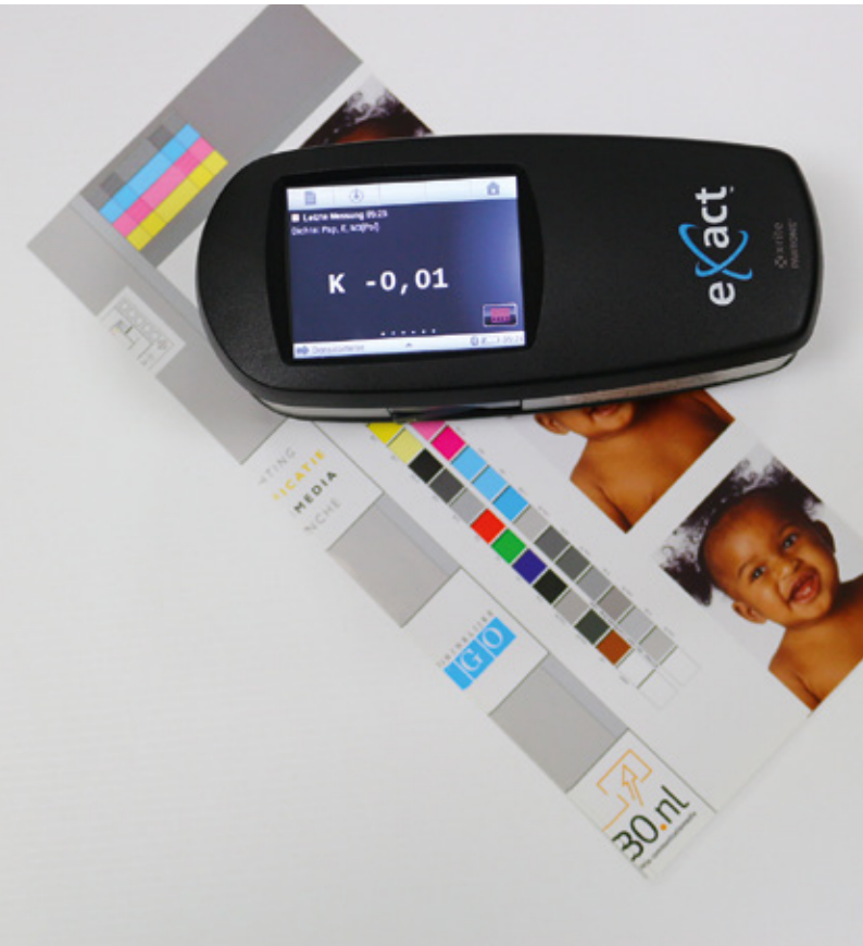
Abb. 5: L^*a^*b^* -Messung am Druckkontroll-Streifen
