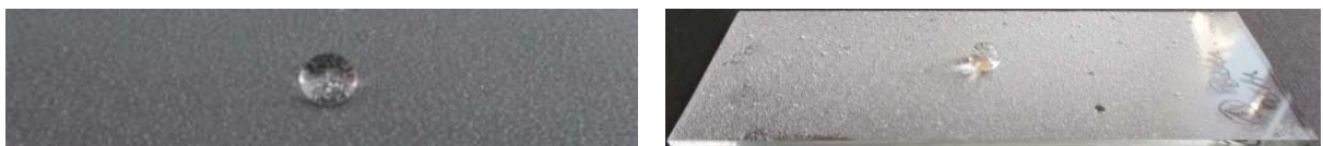
Abbildungen: mikronisiertes Candelillawachs@Lackkarte mit Wassertropfen (li.) mikronisiertes Bienenwachs@Objektträger mit Wassertropfen (re.)
