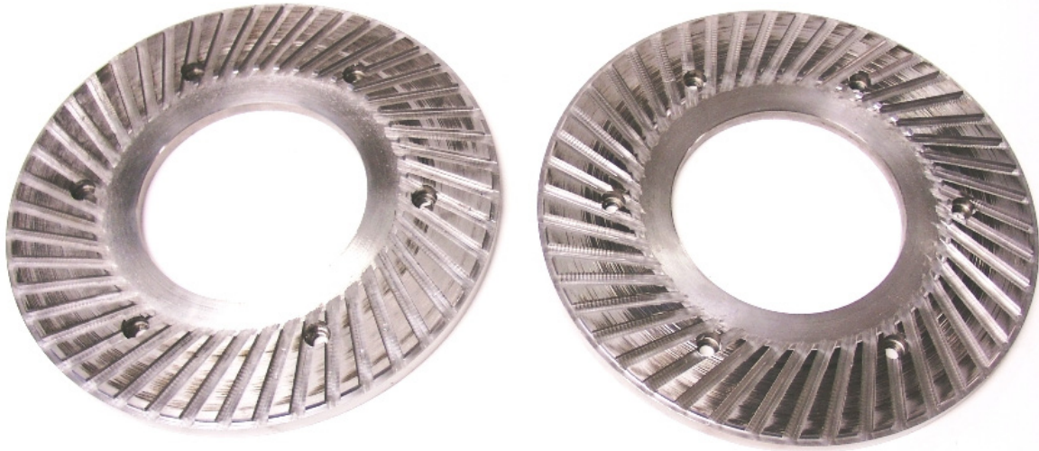
Abb. 5: Scheibengarnitur mit einem Schnittwinkel von 60^\circ
