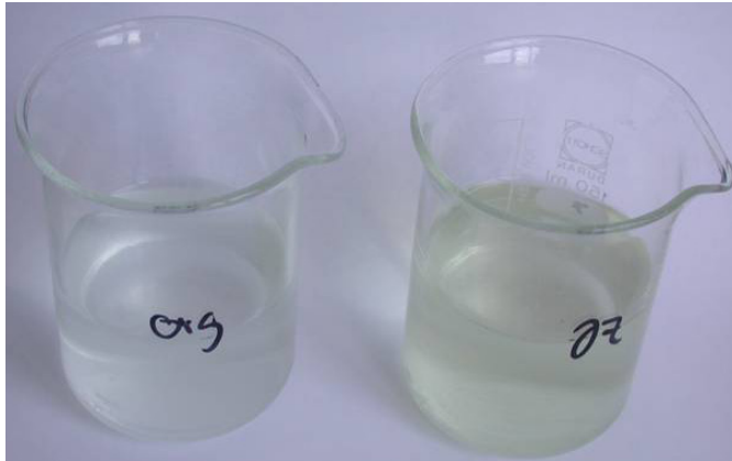
Abb. 7: Zunahme der Färbung durch Ozoneintrag, Werk B
