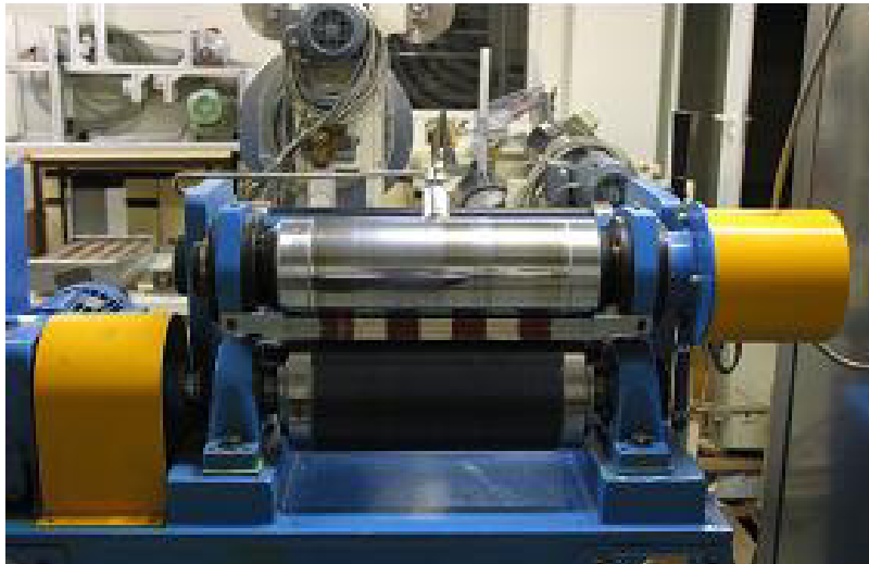
Abbildung 3: Laborkalander der Fa. Kleinewefers zur Satinage der Handrakelmuster
