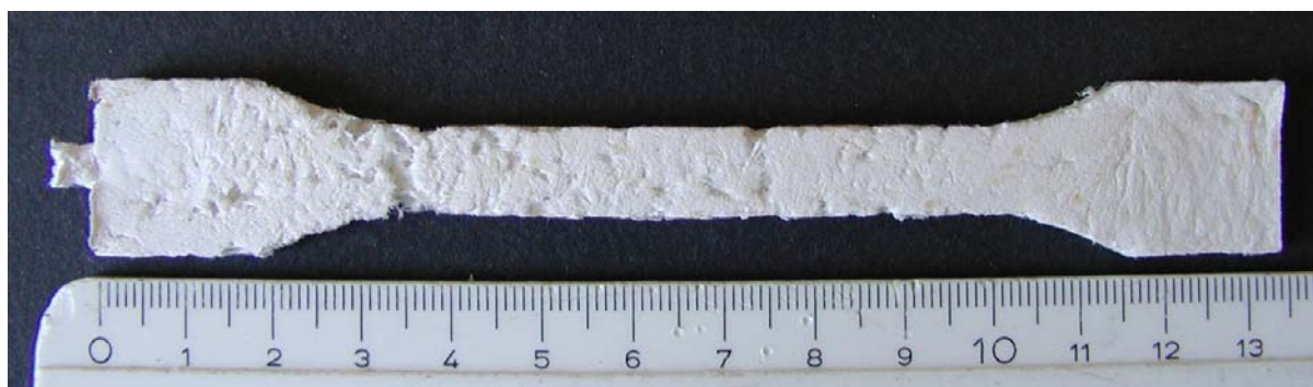
Abbildung 15: Spritzgegossener Zugprüfstab aus Papierfasern [17]
