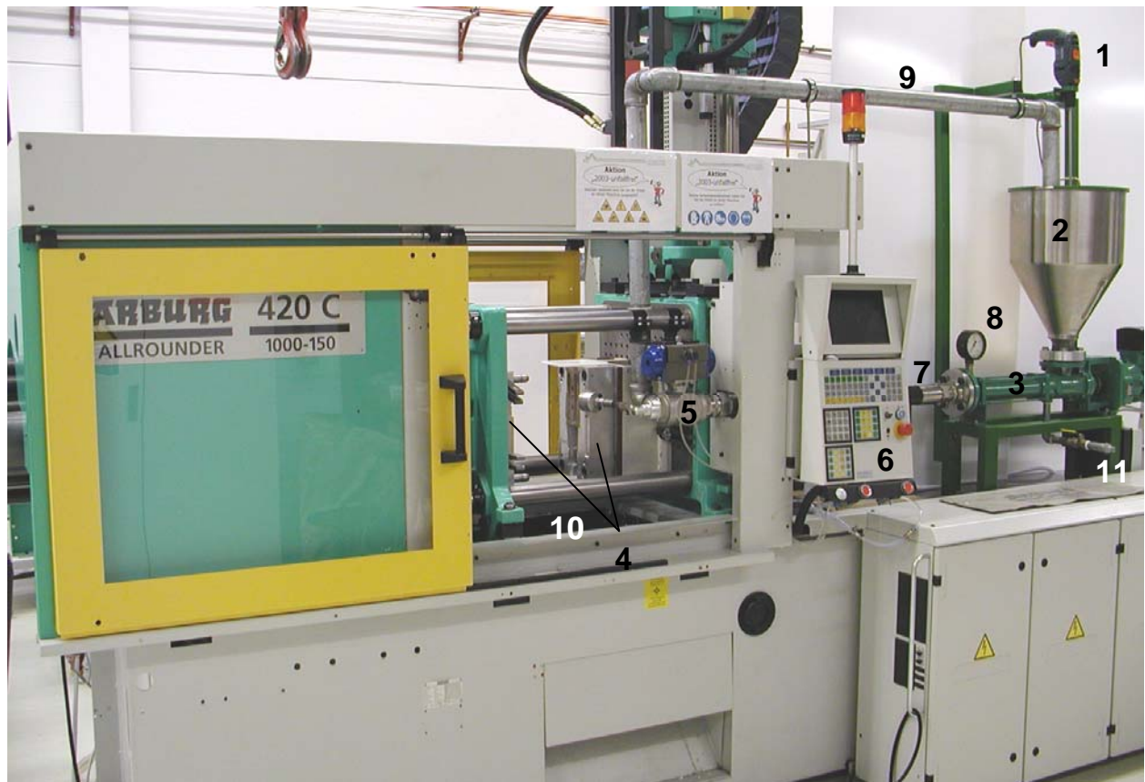
Abbildung 10: Aufbau der Papierspritzguss-Anlage [15] (Beschreibung siehe Text).
