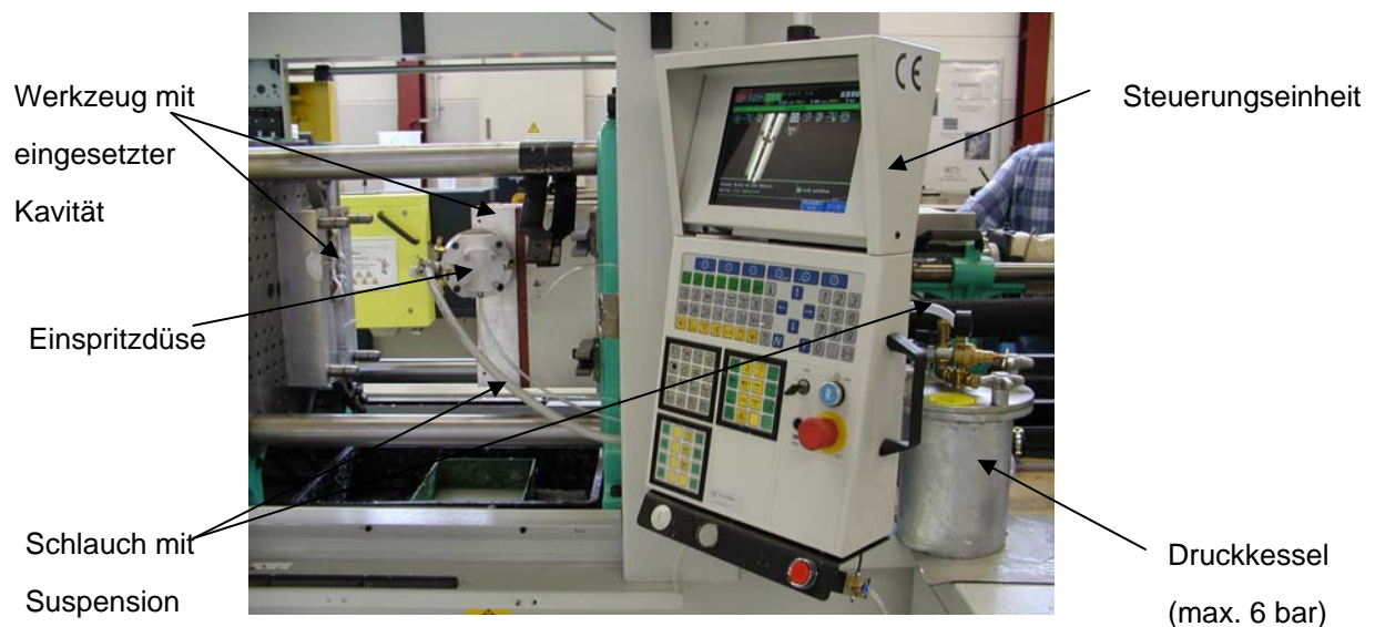
Abbildung 12: Spritzgießanlage mit Nadelverschlussdüse und Druckkessel.
