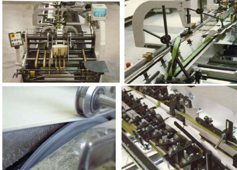
Abbildung 24: Stationen in einer Faltschachtelklebemaschine: Anleger mit Einzug (links oben), Vorbrechstation (rechts oben); Leimauftragswerk - Scheibe (links unten); Falystation (rechts unten) [24]
