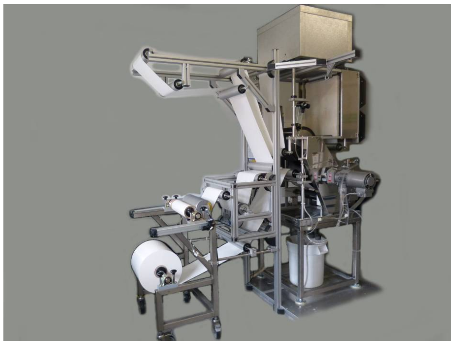
Abb. 3: Kleintechnische Streich- und Beschichtungsanlage der Forschungsstelle 2 (DT-Coater)
