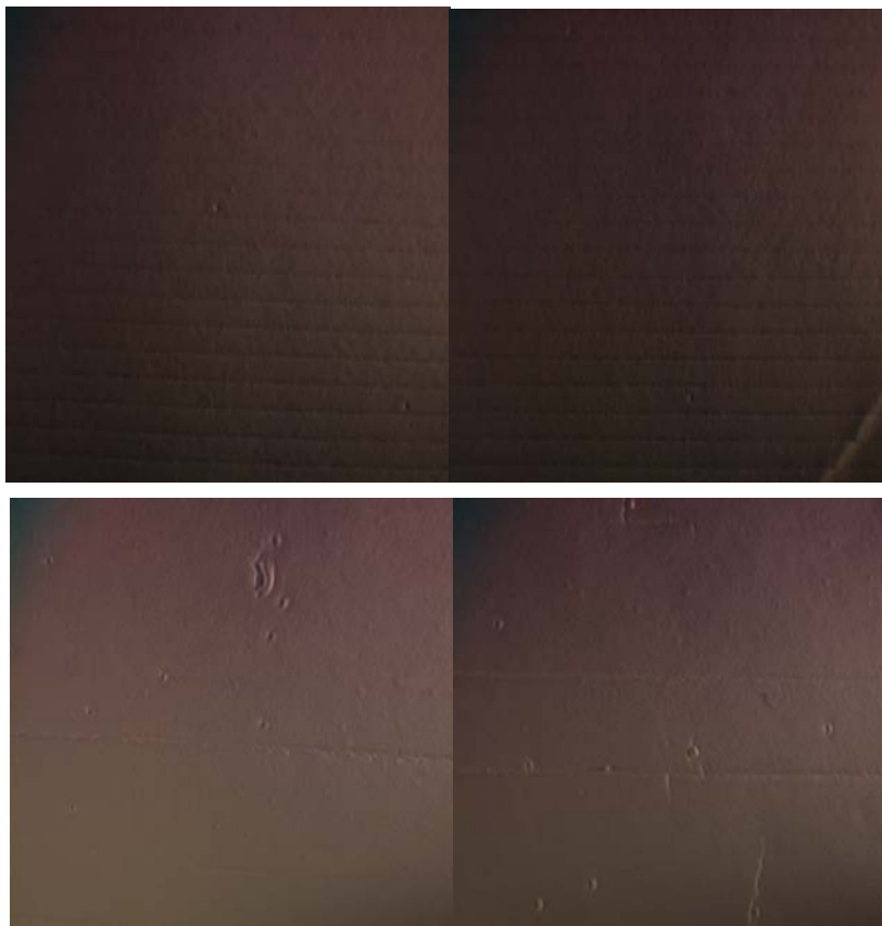
Abbildung 12: Basisrezeptur oben 2249 unten – jeweils rechts mit gerüttelter Bahn (links ungerüttelt)
