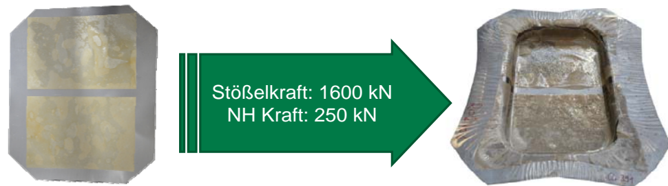
Abb. 4: Tiefgezogenes, im Vorfeld mit imprägniertem Papier versehenes Blechbauteil.
