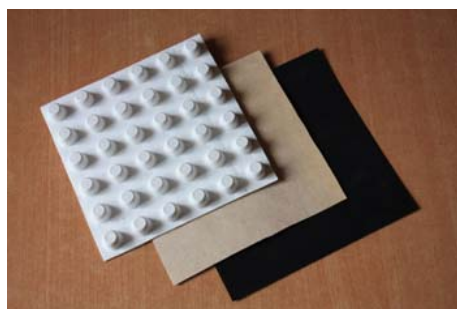
Abb. 3: Beispielhafte Darstellung der Verbundmaterialien: Fasergusskörper (weiß, Noppenwabe), Imprägnierpapier (braun) und Blech (schwarz).
