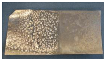
Abbildung 8: Metallisiertes Papier mit sPB PAA (nach Plasma- und PGMA-Behandlung), links hydrophob = unbehandelt, rechts hydrophil = behandelt
