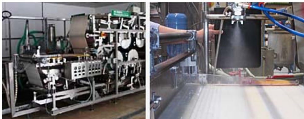
Abbildung 21: Versuchspapiermaschine der PTS in Heidenau (links) und Demonstration der Sprüheinrichtung über dem Langsieb (rechts).
