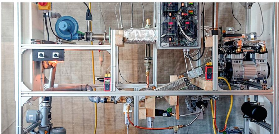
Abb.2: Versuchsträger Wärmerückgewinnung per Taupunktverschiebung
