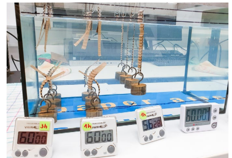
Abb 1. Schematische Darstellung der Versuchsanordnung zur Prüfung der Nassfestigkeit nach FEFCO Nr. 9 (links) und Foto von der Durchführung der Prüfung.
