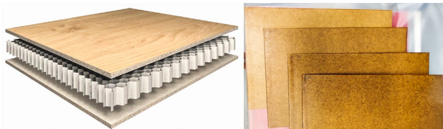
Abb. 1: Möglicher Aufbau des Leichtbauelements mit einem Papierkern und holzbasierten Deckschichten (links); mit flammenschutzaktiver, modifizierter Stärke beschichteter Karton (rechts).
