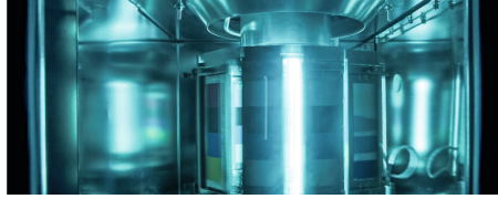
Abb. 2: Beschleunigte Alterung, links: Alterung im Klimaprüfschrank, rechts: Lichtalterung im Xenotest
