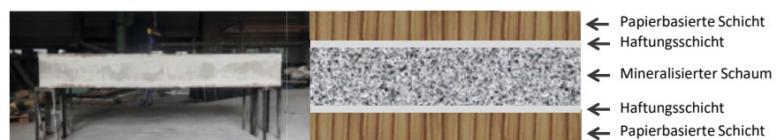
Abb. 2: Demonstratoraufbau Sandwichelement real und schematisch
