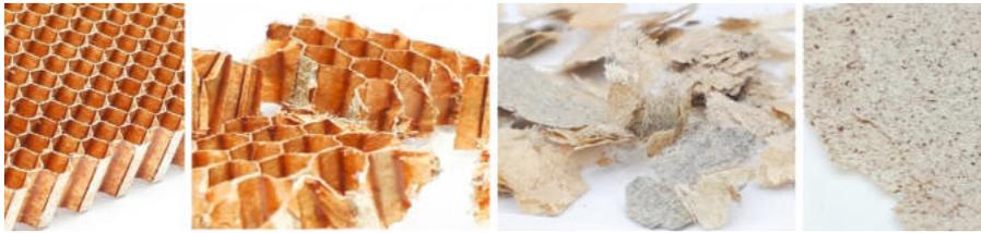
Abb. 1: Altwaben werden zur Ressource für die Papierherstellung – Prozesskette des Aramidwaben-Recyclings. Von links nach rechts: Aramidwaben, mechanisch zerkleinerte Waben oder Wabenverschnitt, phenolharzfreier Faserrückstand nach dem chemischen Recycling und ein daraus hergestelltes Faservlies.
