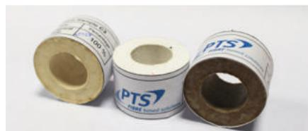
Abb. 2: Referenzproben für PBS II-Handmessgeräte
