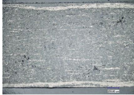
Abb. 3: Sandwichaufbau aus rCF-Hybridvliesstoff mit UD-Decklagen (Quelle: Cetex)
