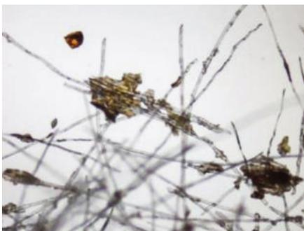
Abb. 2: Aramidfasern nach der Solvolyse, welche noch geringe Mengen an Harzanhaftungen zeigen. Gelingt die Optimierung des Verfahrens, können neue Wertschöpfungsketten zwischen Luftfahrt und Spezialpapierherstellern aufgebaut werden.
