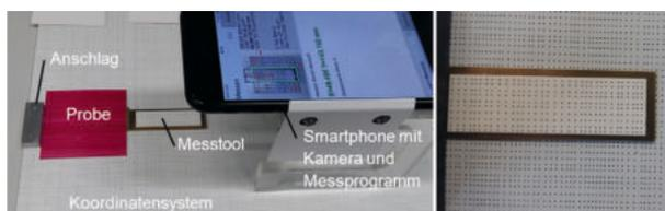
Abb. 1: Messaufbau, Vergrößerung Messtool mit Koordinatensystem.
