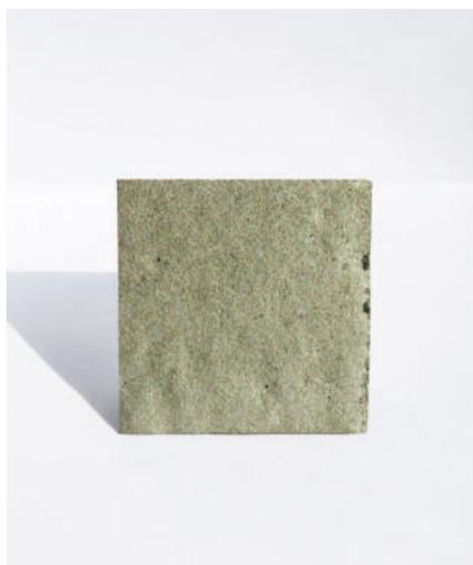
Abb. 2: Gesinterter Titan-Stromverteiler
