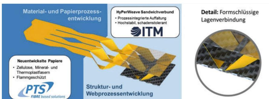
Abb. 1: Schematische Darstellung der Verfahrensschritte zur Erzeugung der HyPerWeave-Struktur mit den Entwicklungsschwerpunkten der Forschungsstellen [links]; Grafische Darstellung der Verbindung von Papier und Textil im Webprozess [rechts] ©ITM
