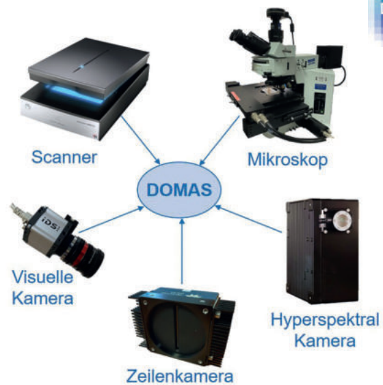
Abb. 1: DOMASmultispec unterstützt eine Vielzahl von Bildaufnahmesystemen. Der flexible Einsatz erlaubt die Entwicklung von spezifischen Lösungen für messtechnische Fragestellungen.
