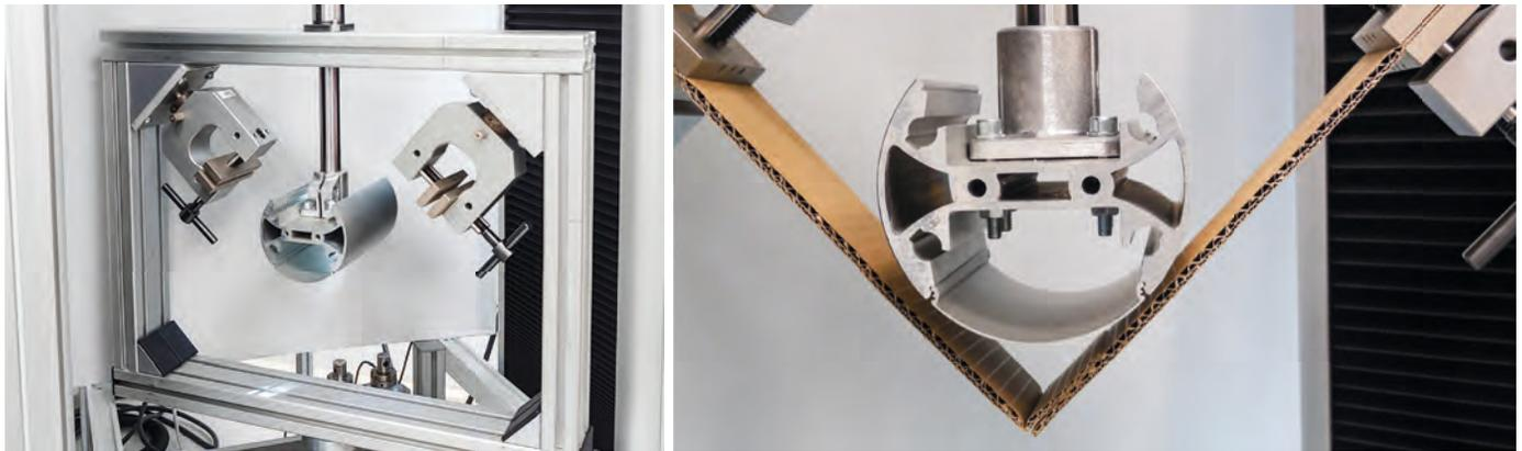
Abb. 1: Prüfvorrichtung zur Ermittlung der Klebnahtfestigkeit nach FEFCO Prüfmethode Nr. 55 ©PTS
