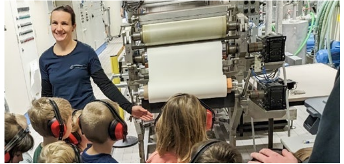
Abb. 4: Das Papier wird am Ende der Papiermaschine aufgewickelt.
