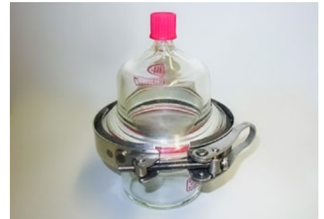
Abb. 2: Migrationszelle aus Glas (einseitiger Kontakt)
