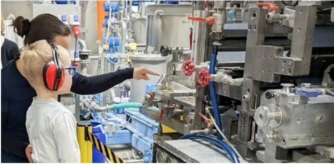
Abb. 3: Erklärungen am Stoffauflauf der Papiermaschine
