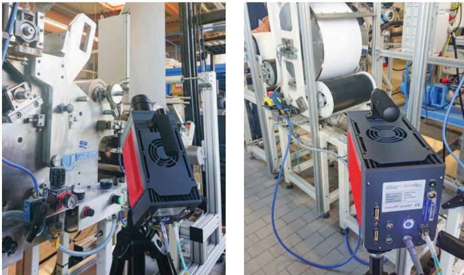
**Abb. 3:** Messaufbau der Kamera am Heizzylinder (li) sowie an der Infrartheizung (re.) der Streichmaschine des PTS Technikums
