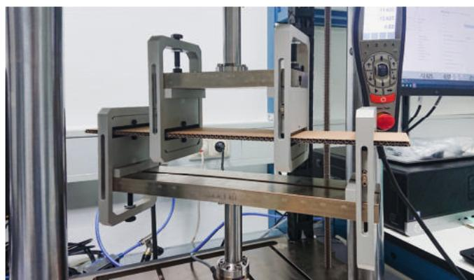
**Abb. 5:** 4-Punkt-Biegebank zur Durchführung von (Wechsel-) Biegeversuchen
