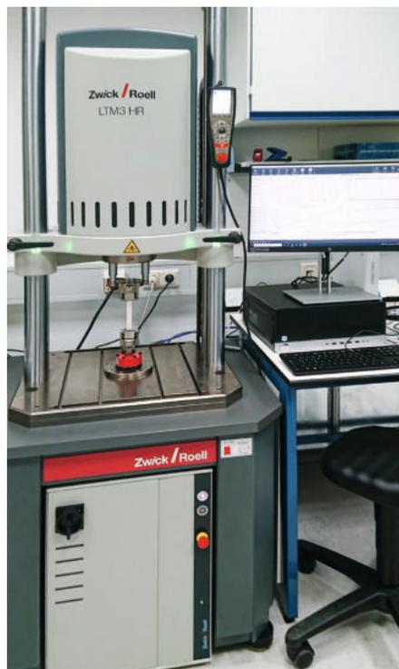
**Abb. 1:** Elektro-Dynamische Prüfmaschine LTM 3 HR inkl. PC-Arbeitsplatz in den Laboren der Papiertechnischen Stiftung (PTS)
