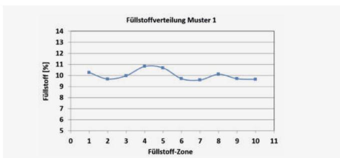
**Abb. 2:** Papier mit gleichmäßiger Füllstoffverteilung in z-Richtung
