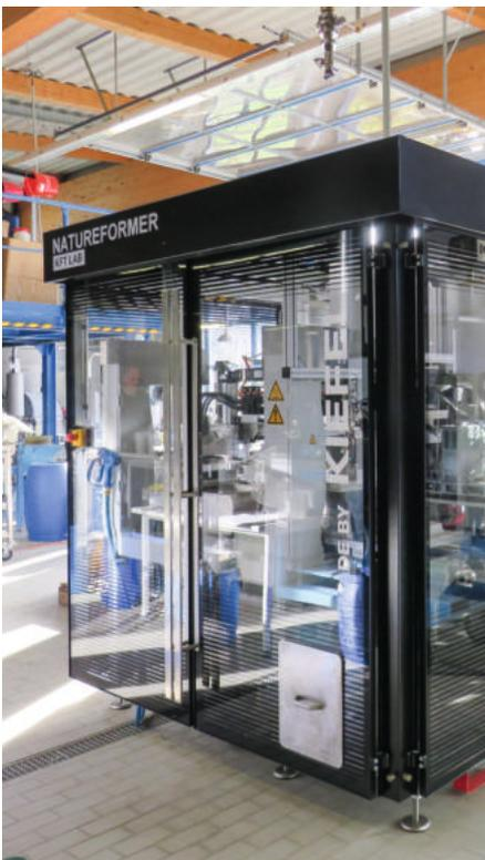
Anfang November 2022 wurde eine durch das BMWK im Rahmen des INNO-KOM-Investitionszuschusses geförderte KFT Lab Kiefel Fiber Thermoformmaschine zur Herstellung von Faserguss-Formkörpern im Nassverfahren erfolgreich in Betrieb genommen.
