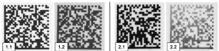
Abb. 1: Alterungsprozess am Beispiel Data Matrix Code: 1.1. ungealtert, 1.2 Alterung im Klimaschrank bei 80 °C / 65 % | 2.1 ungealtert, 2.2 Alterung im Xenotest bis Lichtechtheitsstufe 6
