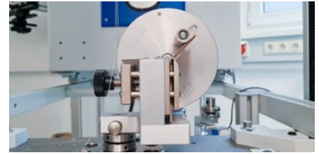
Abb. 1: Prüfvorrichtung zur Ermittlung des Faltfaktors nach DIN 19304
