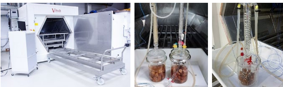
Abb. 2: Industriemikrowellenofen HEPHAISTOS und zwei verschiedene Versuchsaufbauten in der Mikrowelle: Gekoppelte 3,5 L Reaktoren (Mitte) sowie Kolben mit Rückflusskühler (rechts). (Fraunhofer IAP, TH Wildau)
