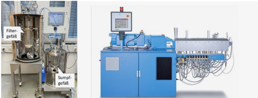
Abb. 2: Hochkonsistenz-Modifikationstechnologien an der PTS. Links: Druckfiltrationsreaktor mit Filter- und Sumpfgefäß für eine scherarme Reaktionsführung im Hochkonsistenzbereich. Rechts: Extruder zur reaktiven Extrusion im technischen Maßstab.
