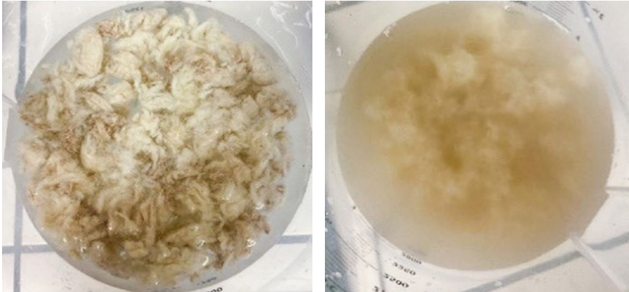
Abb. 3: Rezyklatfaserprobe in Wasser suspendiert vor (links) und nach (rechts) Desintegration
