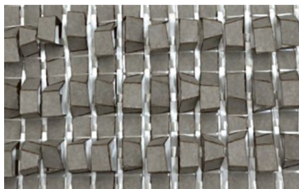
Abb. 2: Zwischenstufe (Kern und einer Decklage zur Veranschaulichung) bei der Herstellung eines Demonstrators mit dem Zellstoff-Basaltfaser-Hybrid als Kernmaterial
