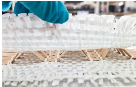
Abb. 1: Demonstrator aus dem Projekt HyPerWeave, bestehend aus einem Kartonmaterial im Kern, webtechnisch verbunden mit einem Glasfasergewebe; vor (links) und nach (rechts) der Imprägnierung mit Phenolharz
