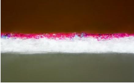
Abb. 2: Bestimmung der Tinteneindringtiefe, Querschnitt durch ein bedrucktes Substrat
