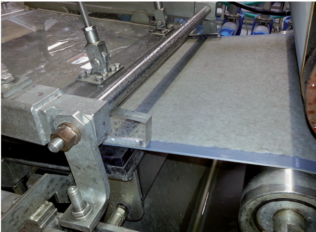
Abb. 2: Hybridvliesstoff nach Vlieslegung auf der Versuchspapiermaschine (Quelle: PTS).
