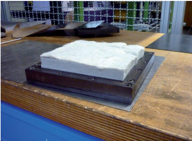
Abb. 5: Hybridvliesstoffe vor dem Pressvorgang (Quelle: Cetex).
