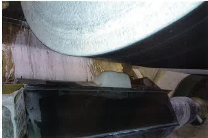
Abb. 2: Jetflow F mit begrenzter Auftragsbreite – Der Strichauftrag betrug 11 g/m<sup>2</sup>.
