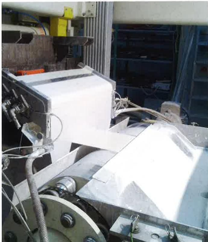
Abb. 1: Curtain Coater mit Vor- und Deckstrich beim Overboard Gießen
