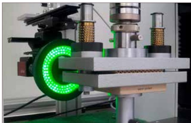
**Abbildung 1:** Beispiel eines Messaufbaus für optisch begleitete FCT-Messungen. Kamerasystem, Beleuchtung, FCT-Universalprüfmaschineneinbau (v.l.n.r.)
