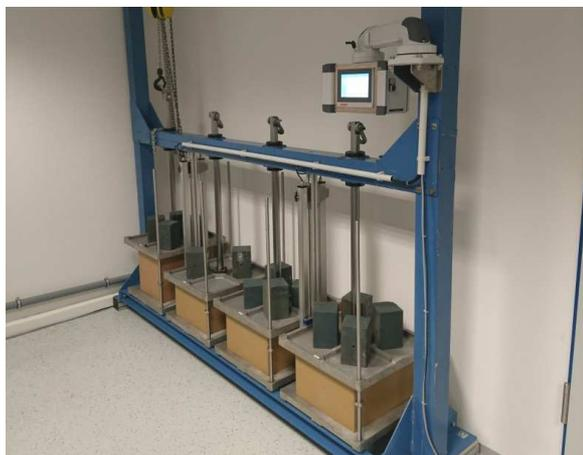
**Abbildung 45: Langzeit-BCT-Versuchsstand für Packmittel kleinerer Maße**
