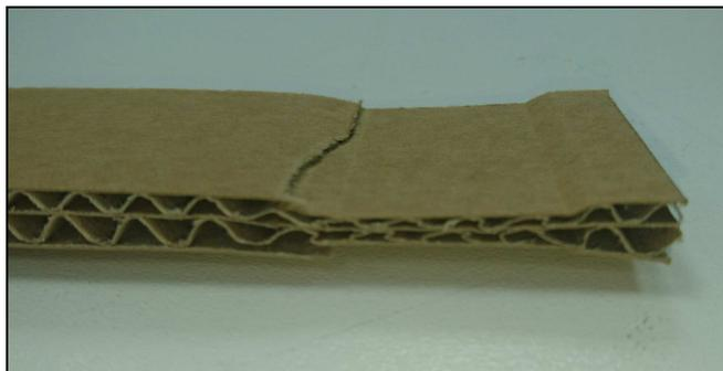
**Abbildung 10: Schadensbild beim Zugversuch an Wellpappe**
