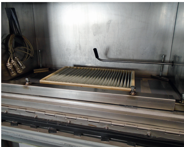
Abb. 5: Labormuster im Prüfstand (li.), Fraktionsabscheidegrade des Labormuster-Filters im Bereich PM 2,5 (re.) (Quelle: ILK).
