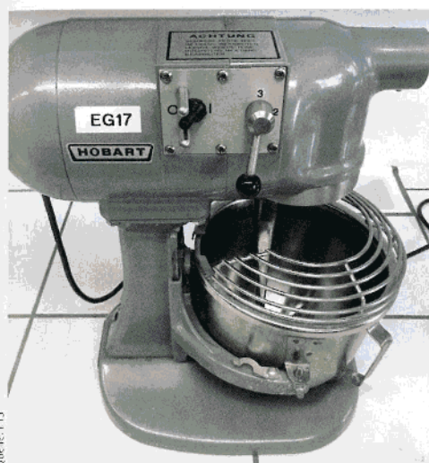
Abb. 9: Eingesetzter Laborpulper für Referenzversuche mit Kalkmilch und Zellstoff ohne mechanischen Zellstoffabbau
