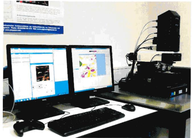
Abbildung 2: Raman-Mikroskop mit Monitoren für Mess- und Auswertsoftware
