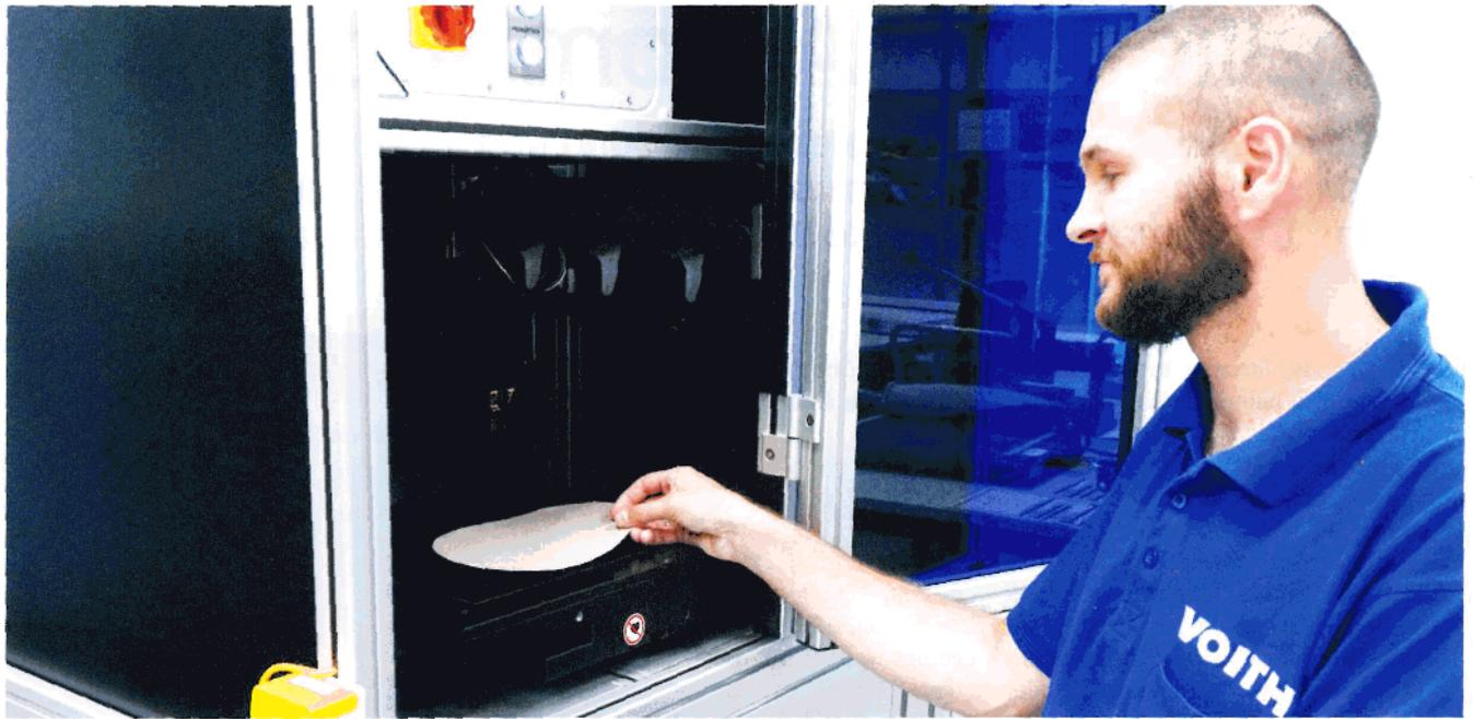
Mittels einer Nah-Infrarot-Kamera werden klebende und nicht-klebende Verunreinigungen im Papier zuverlässig und detailreich ermittelt.
