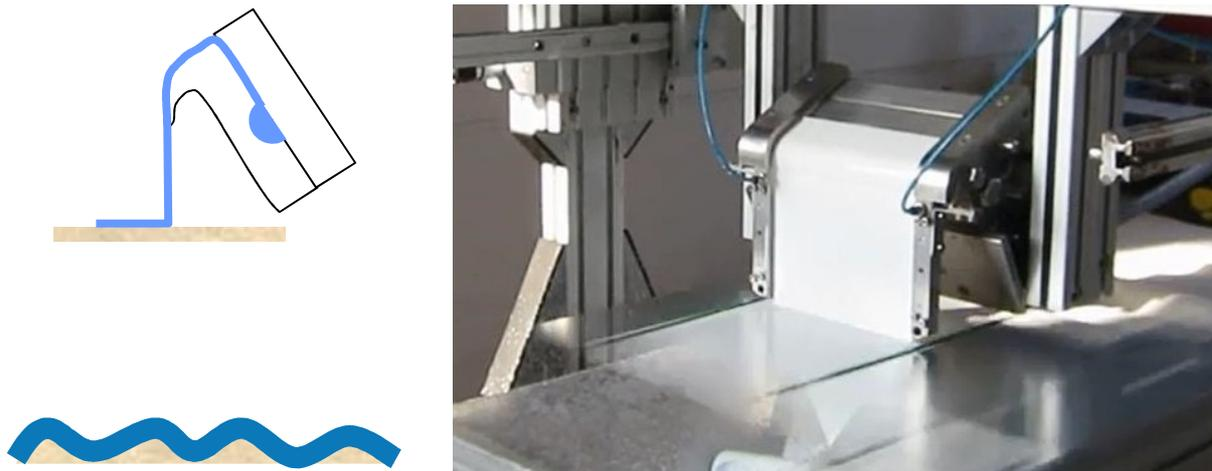
Abbildung 7: Curtain Coater, links oben: Prinzipskizze, links unten: idealer Konturstrich, rechts: Curtain Coater an der PTS
