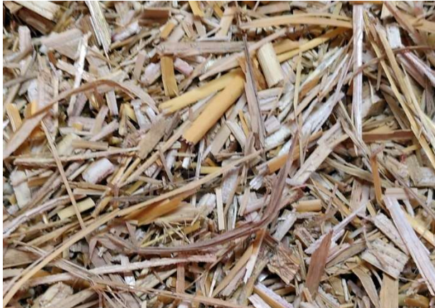
Abb. 7. Miscanthus nach Verarbeitung mit Messerringzerspaner, Fa. Jähmlich (4 bis 35 mm)
