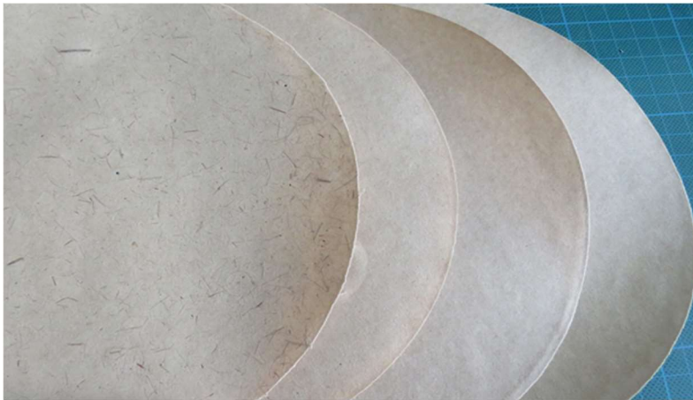
Abb. 25: Laborblätter CTMP V III PFI Mühle von links nach rechts: ungemahlen, 2000 U, 4000 U und 6000 U
