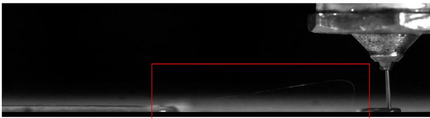
Abbildung 12 – Analyse des Fadenzugverhalten des BioGlyk-Versuchsmaterials mittels High-Speed-Videos
