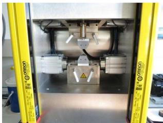
Abbildung 5: WKM-Messgerät zur Ermittlung der Klebkraft von Schmelzklebstoffen
