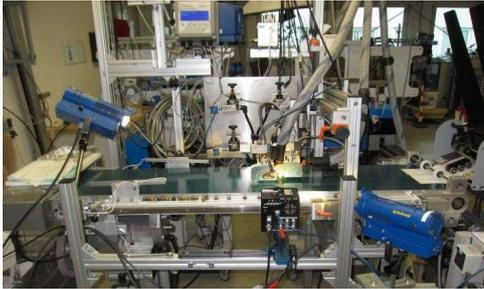
Abbildung 2 – Testaufbau mit High-Speed-Kamera, Beleuchtung und LogiComm Steuerung
