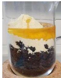
Abbildung 36: Mischung aus Stärkemischester, Kolophonium und Öl bei  $t = 0$  min und  $T = RT$ .
