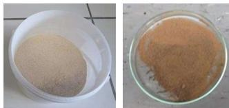
Abbildung 13: Mittels in-situ Reaktion im Process 11 hergestelltes Weizenstärkeacetobutyrate BIGL\_no\_118 (links) und Weizenstärkebutyrate BIGL\_no\_120 (rechts)
