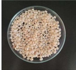
Abbildung 41: PBAT-basiertes Polymer
