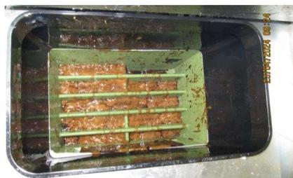
Abbildung 6 – BioGlyk-Versuchsmaterial nach ca. 6,5 Stunden auf Verarbeitungstemperatur (170°C)
