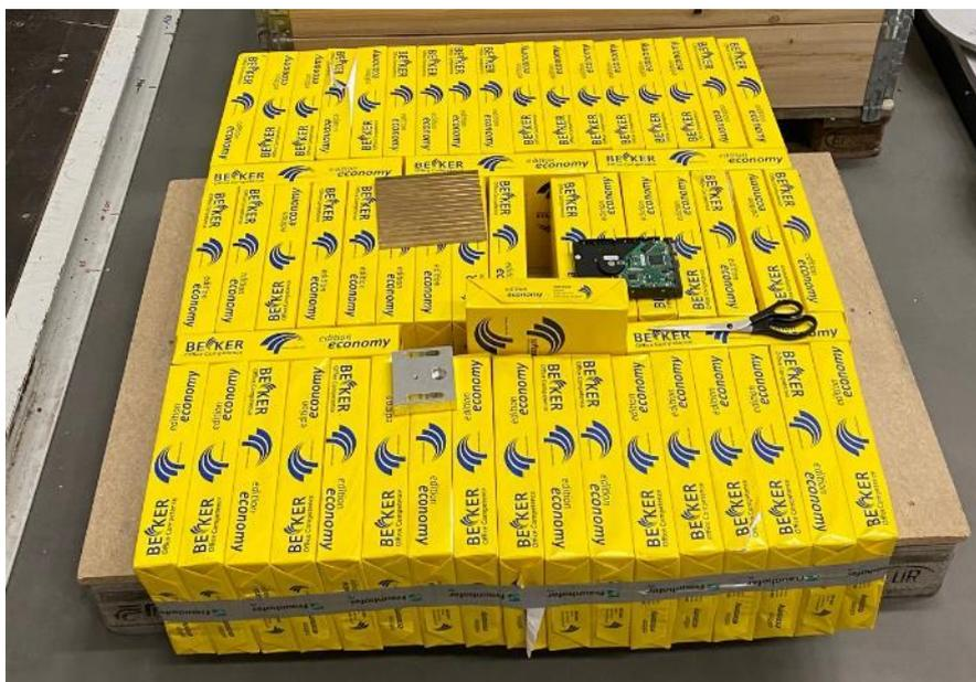
*Abbildung 19: Simulierter realer Ballen zur Einrichtung des XXL CT-Scanners mit eingebrachten Fremdbestandteilen*
