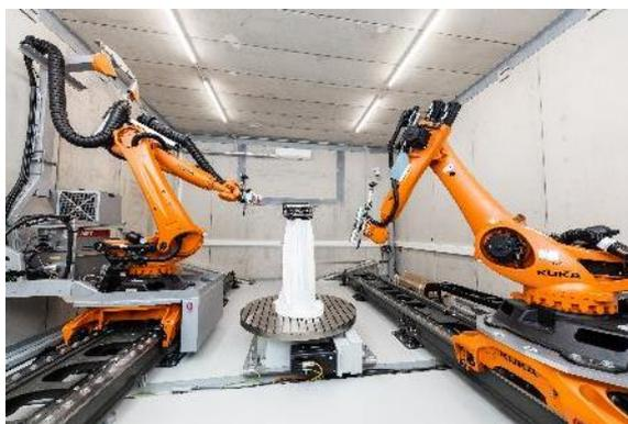
Darüber hinaus betreibt das Fraunhofer EZRT am Standort Fürth die weltweit größte zivil zugängliche CT-Anlage mit einem Linearbeschleuniger als Strahlungsquelle. Diese Systeme können Objekte bis hin zu einer Größe eines Automobils digitalisieren und sind Gegenstand aktueller Forschung.
