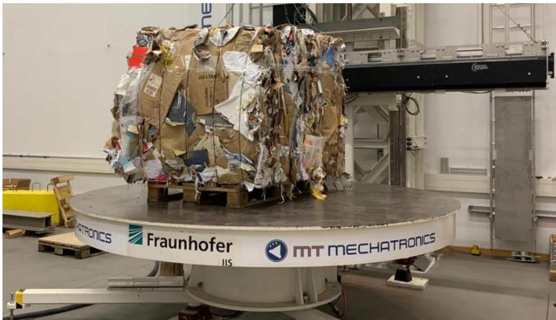
Abbildung 31: Ballen der Sorte 1.04 auf dem Versuchsstand des Fraunhofer IIS
