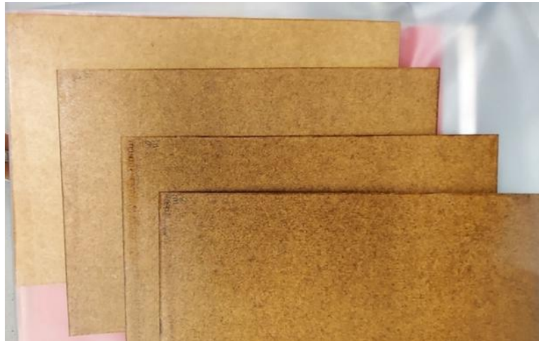
Abb. 5-12: Mit Flammenschutzstärke imprägnierte Kartons nach unterschiedlicher Anzahl von Imprägnierdurchgängen
