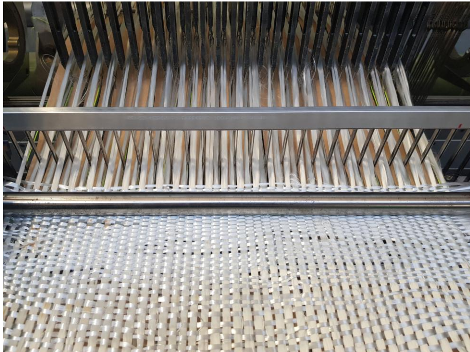
Abb. 12-7: Musterherstellung auf der Webmaschine
