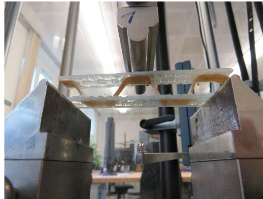
Abb. 5-19: Versuchsaufbau für die Ermittlung der Biegeeigenschaften
