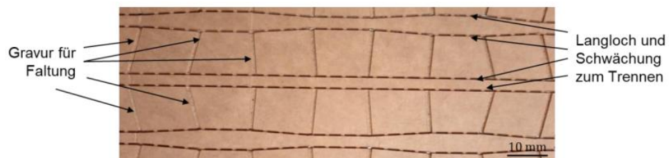
Abb. 13-2: Bearbeitete Papierbahn mit Trenn- und Faltlinien (Industriematerial)
