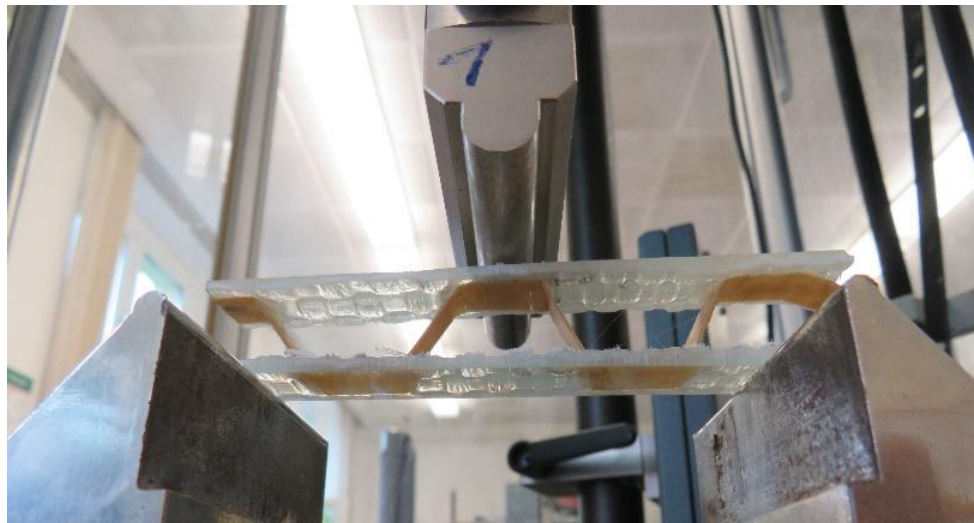
Abb. 14-5: Versuchsaufbau des 3-Punkt-Biegeversuchs
