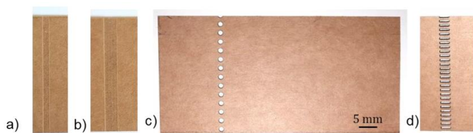
Abb. 11-5: In Faltpunkten eingebrachte Strukturen: a) Gravur mit einer Breite von 2 mm, b) Gravur mit einer Breite von 4 mm, c) komplette Probe mit Lochstruktur und d) Langlochstruktur
