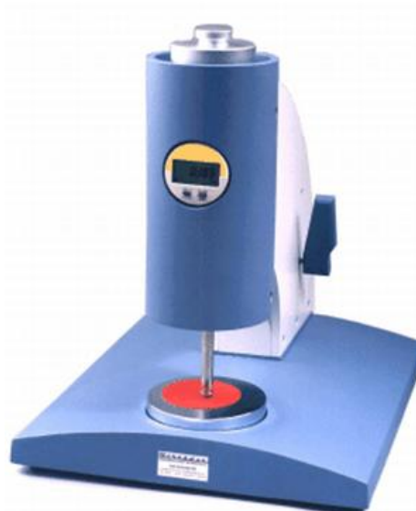
Abb. 5-16: Dickenmessgerät SYLVAC S229 der Fa. Karl Schröder KG
