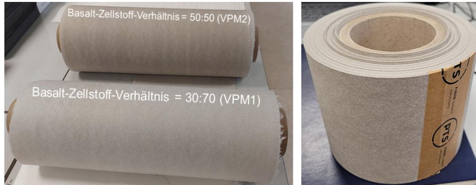
Abb. 10-2: Hybridmaterial nach der Herstellung auf der Versuchspapiermaschine: die beiden Varianten in voller Rollenbreite (45 cm, links), für Laserbearbeitung zugeschnittene Schmalrolle (Breite 12 cm, rechts)
