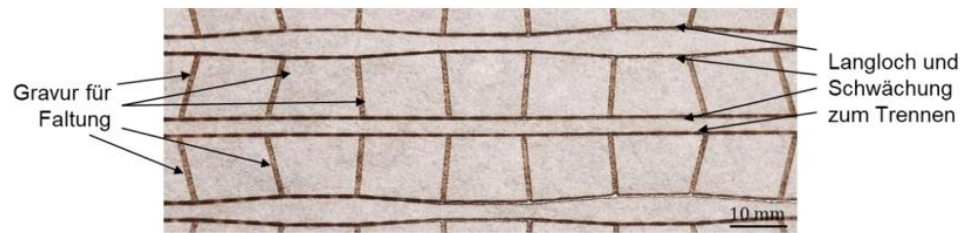
Abb. 13-3: Bearbeitete Papierbahn mit Trenn- und Faltlinien (Hybridmaterial)
