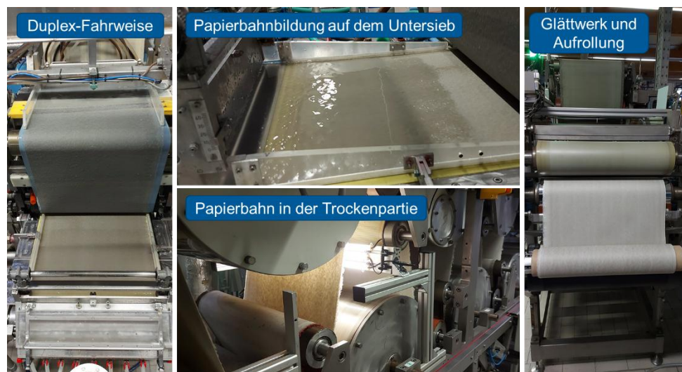
Abb. 10-1: Verschiedene Abschnitte der Erzeugung des Hybridmaterials an der Versuchspapiermaschine der PTS
