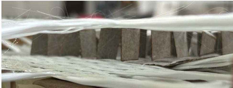
Abb. 1-2: Demonstrator aus GF-Gewebe und Papierbändern aus Zellstoff-Basaltfaser-Hybridmaterial
