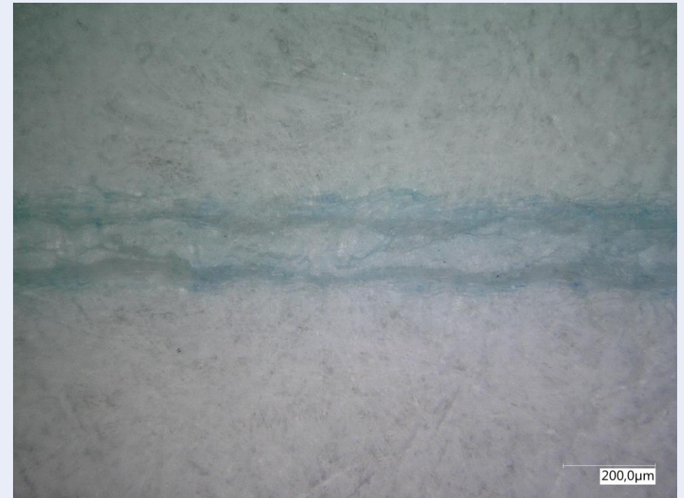
OGR 11, 10 g/m 2 , künstl. Falzbruch + Pinholetest, Oberfläche, 250x
